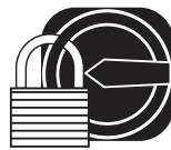
Glavno napajalno stikalo morate obrniti v izklopljen položaj »0« in ga zavarovati s ključavnico.
